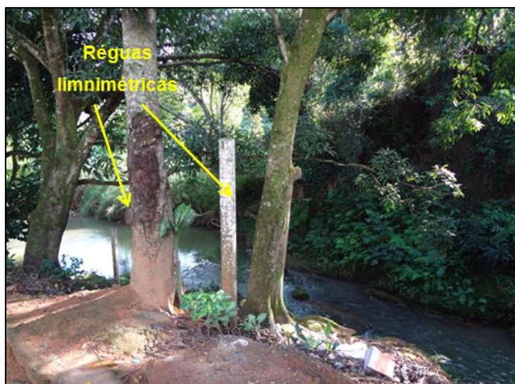
Figura 4-14 - Seção de monitoramento (Monitoramento 1) do nível d'água no rio Fundão/Reis Magos, bairro Beira Rio.
