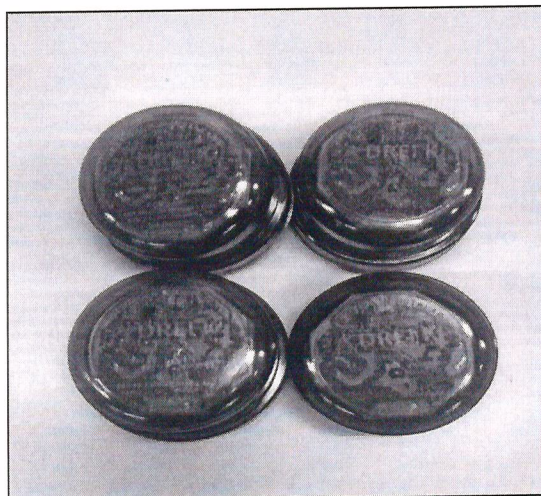
Figura 01 – Relés Fotoelétricos a serem ensaiados
